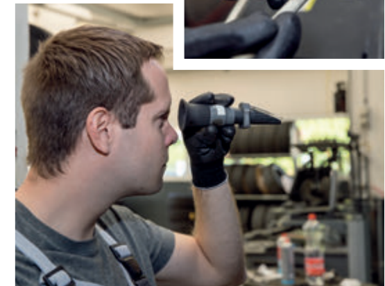
Wir überprüfen den Gefrierpunkt des Frostschutzmittels mit einem Refraktometer.
