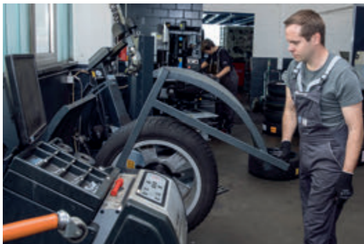
Die Reifen müssen ausgewuchtet werden, damit sie sauber laufen.
