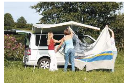
Das Zeltdach wird am Reisemobil befestigt und dann über das Gerüst ausgebreitet: Bei Sturm können Sie jetzt schon abspannen!
