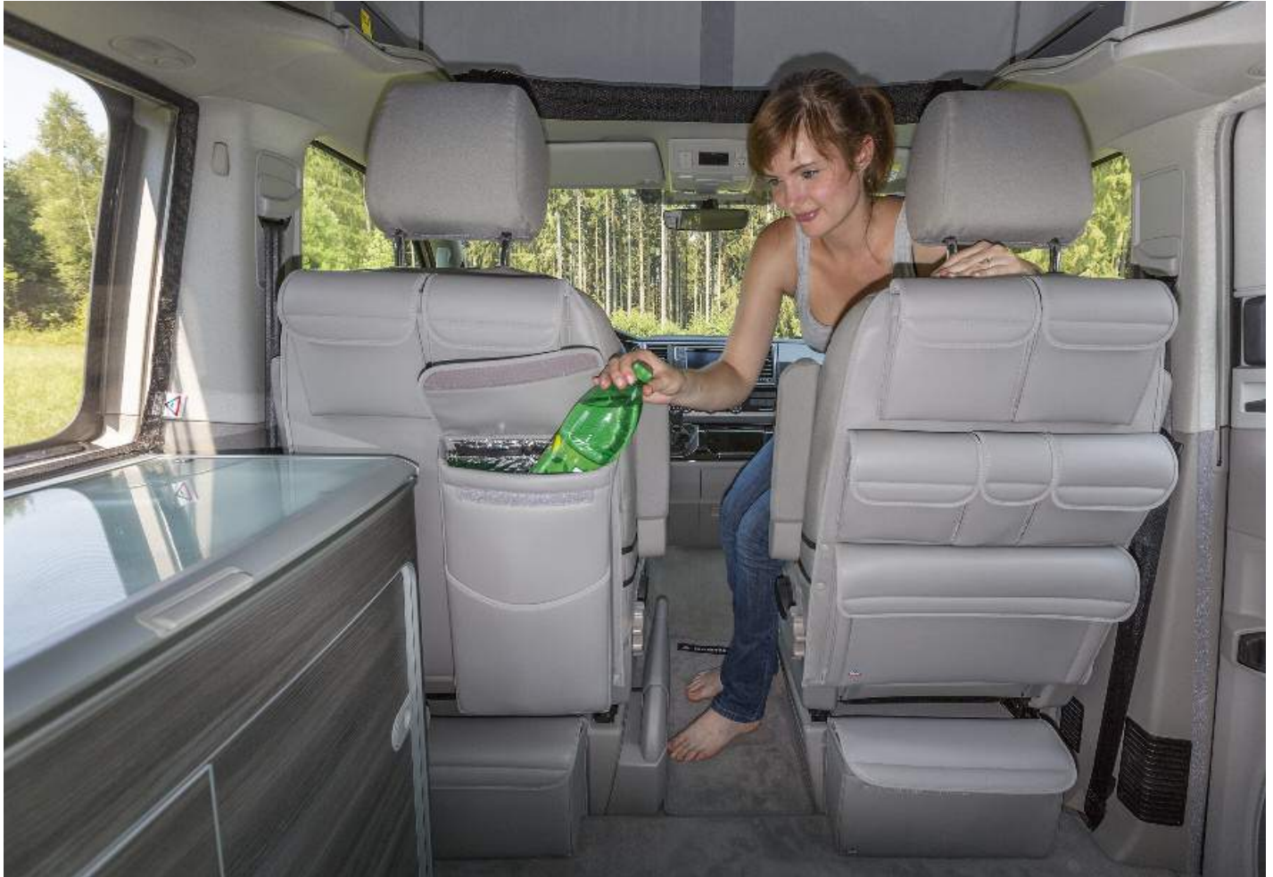
Utility für den linken Fahrerhaussitz mit integrierter MULTIBOX: Isolierbox + unsichtbarer Abfallbehälter + Stauraum. Die Multibox ist innen mit isolierendem und stoßdämmendem Material ausgekleidet und hat Isoliertaschen-Qualität. Auch 2-Liter-Getränkeflaschen haben Platz. Wenn man eher einen Abfallbehälter benötigt, ermöglichen zwei Halterungen das Einhängen und Befestigen eines handelsüblichen 20-Liter-Abfallbeutels mit Griffen. Rechts: Utility für den Beifahrersitz bietet sehr viel Stauraum.
