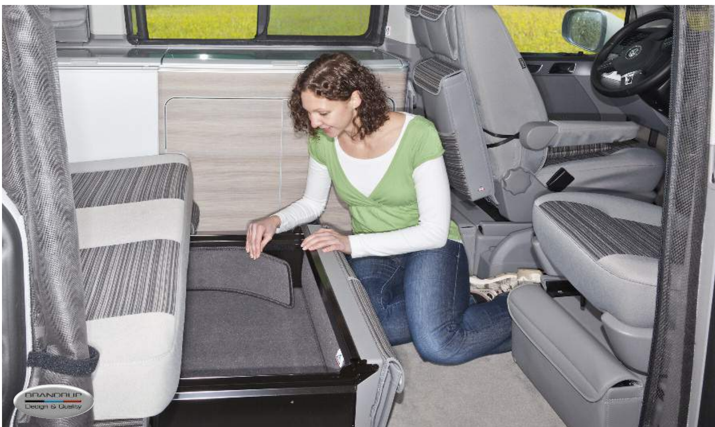
Geräuschdämm-Matte und -Set California T6/T5: Sind ideal zur „Beruhigung“ der Blechschublade unter dem Bett (2er-Sitzbank): Abgelegte Sachen „klappern“ nicht mehr und sind besser geschützt. Die Markisenkurbel kann weiterhin eingeklipst werden. Die Geräuschdämm-Matte (Boden) wird in die Schublade eingelegt. Das Geräuschdämm-Set (Seitenteile) hat oben Klettverschluss.
