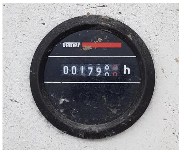
Ein an der Maschine vom CIFA angebrachter Stundenzähler
