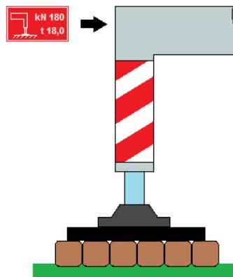
Mit den bekannten Werten des zulässigen Bodendrucks [kN/m<sup>2</sup>] und der Last [kN] kann die erforderliche Stützfläche berechnet werden. Die Grundlage dafür bildet die nachstehende Tabelle. Die Tabelle gibt die Länge der Hölzer an, die zu den Abstützplatten mit den Abmessungen 60cm x 60cm hinzugefügt werden müssen.
