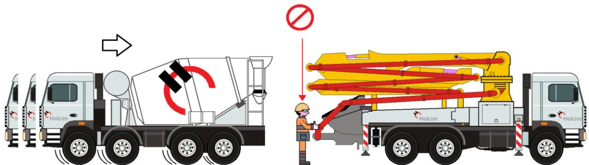
Jede Person, die dem Fahrer des zurücksetzenden Fahrmischers Fahrhinweise gibt, muss sich neben dem Fahrzeug und stets im Sichtfeld des Fahrers befinden.
